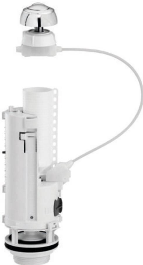
Batteria di scarico monoblocco con doppio volume di scarico, garantita 10 anni, comando con cavo metallico, montaggio facile e veloce, pulsante e corona cromati.
