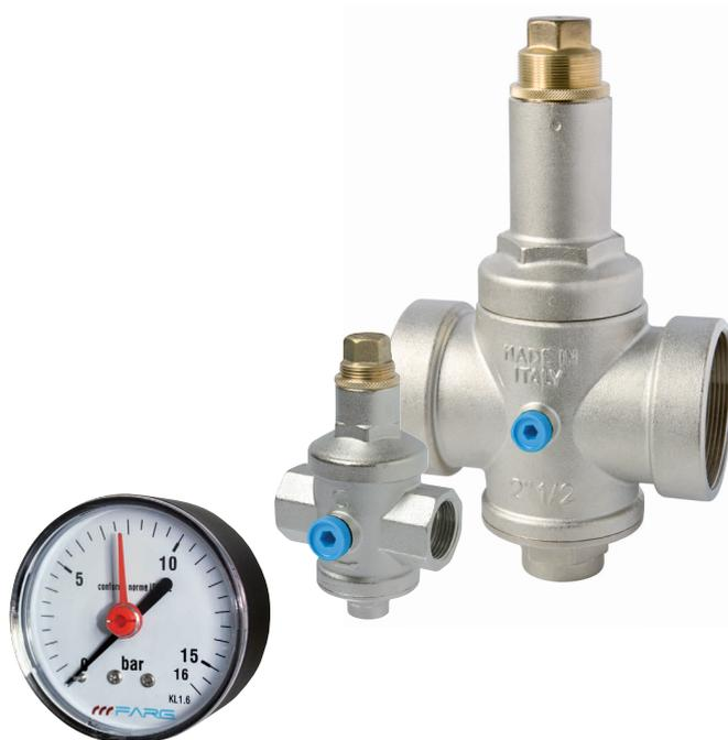
Il riduttore di pressione F.F. con sede inox è indicato principalmente in impianti, sia civili che industriali, in cui si richiedono portate medio-alte, con la garanzia inoltre, della sede di tenuta in acciaio inossidabile. Caratteristica principale è il funzionamento a pistone con camera di compensazione. Gli attacchi per il collegamento all'impianto sono femmina filettati secondo la norma ISO 228/1.
